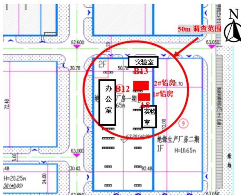
图 6-1 (2) X 射线实时成像检测系统周围现场检测布点示意图
