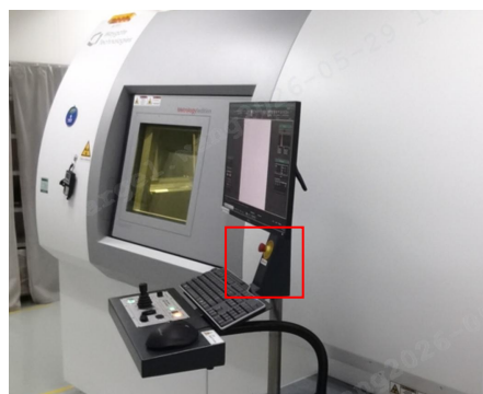
图 3-4 1 车间设备控制台处紧急停机按钮及标签
