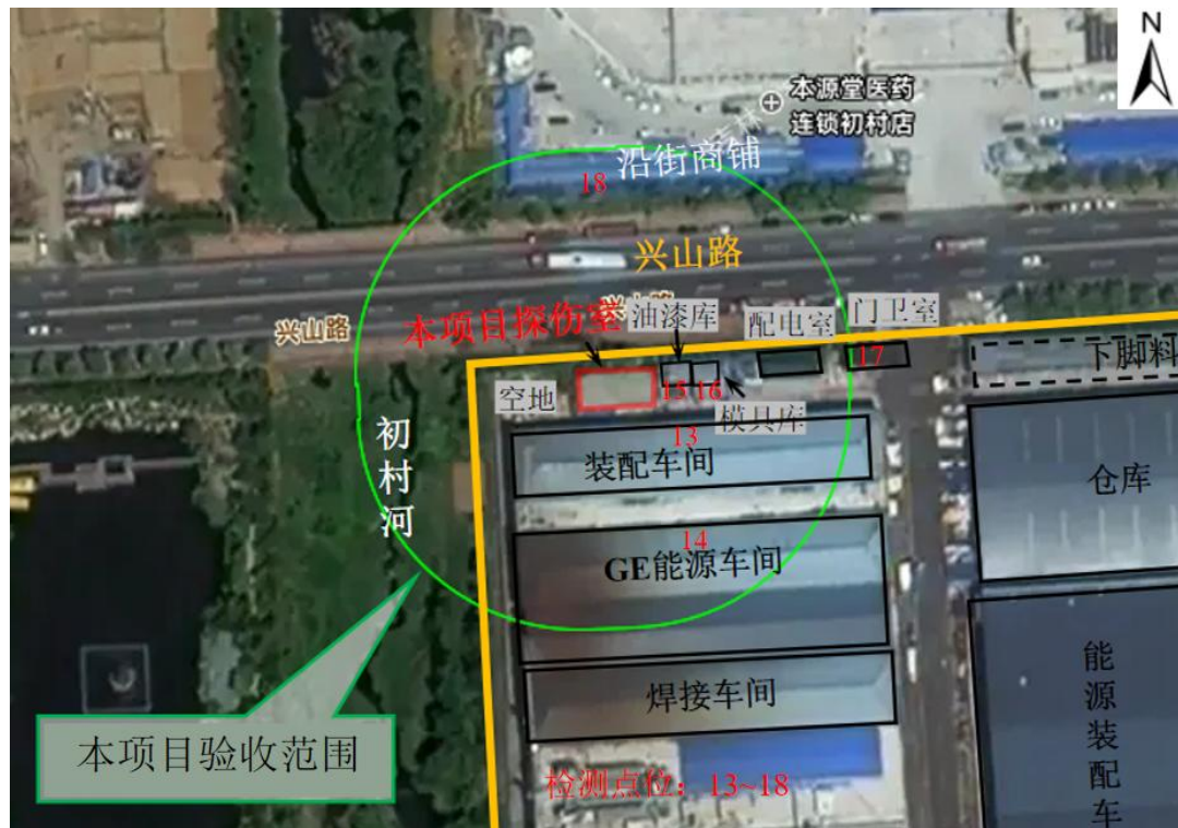
图6-2 (b) X射线探伤机开机状态下监测布点图
