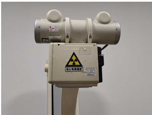
探伤机上张贴电离辐射警告标志
