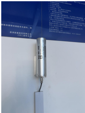
固定式辐射监测仪探头（操作室内）
