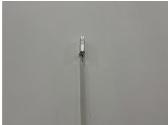
固定式辐射监测仪探头（探伤室内）
