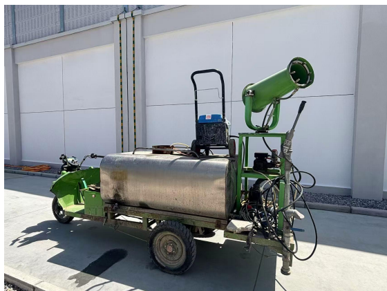
洒水降尘照片
