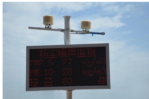
图6-4 变电站施工场地扬尘监测
