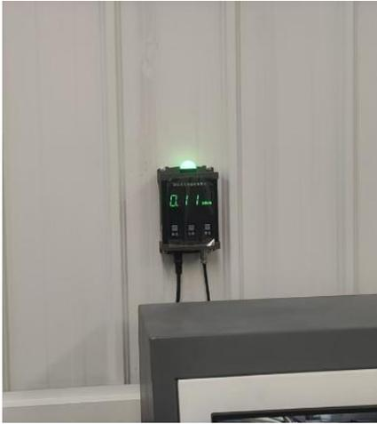
图 3-7 在线辐射监测报警装置
