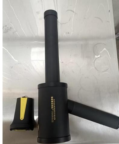
图 3-8 辐射巡检仪及个人剂量报警仪
