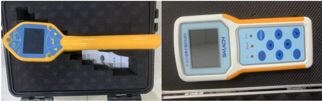
RJ33-1015 型多功能辐射检测仪 R-EGD 便携式辐射检测仪
